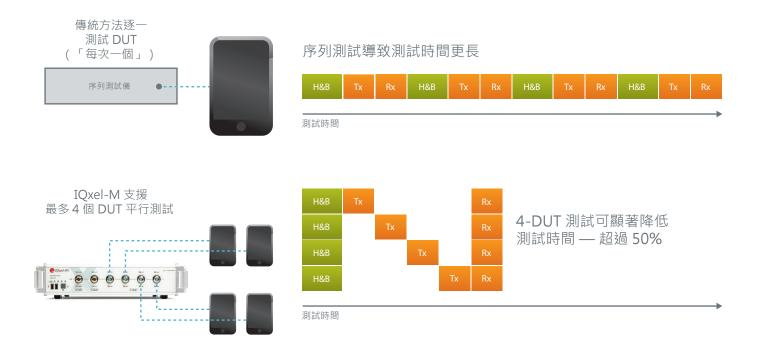
雖然同步平行測試可明顯提高測試處理量的優勢,但工廠在此類部署時可能會對資本支出、生產線設定甚至員工訓練皆有一定影響。使用IQxel-M進行非同步平行測試,則可重用現有資本設備(例如單設備屏蔽盒(single-device shielded boxes))、保留一般工廠常用設定和操作者使用方式,同時可將多個測試台整合在一處。如此一來,即可節省占用寶貴的工廠面積,同時降低人工、電力和管理費用等營運支出。如果需要進一步的擴張之時,可將IQxel-M重新部署為同步平行測試配置,獲得更顯著的處理量提升並節約營運支出。
